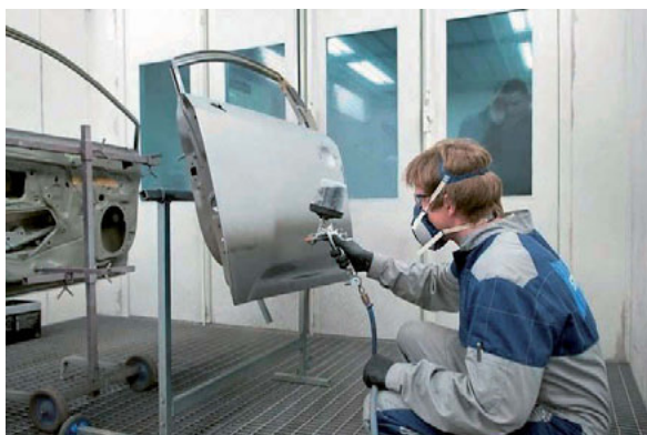
Foto 108, 109 – Eraldi detailide üleni kruntimisel alustage täitevkrundi pihustamist detaili alaosast ja liikuge järk-järgult ülespoole
