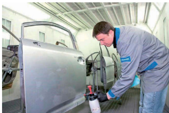
Fotod 7 ja 8 – Pesuaine pihustatakse pinnale ühtlase kihina, kasutades selleks mõeldud survepudelit
