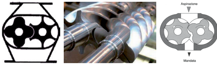
Joonis 18 – Kruvikompressori tööpõhimõte
