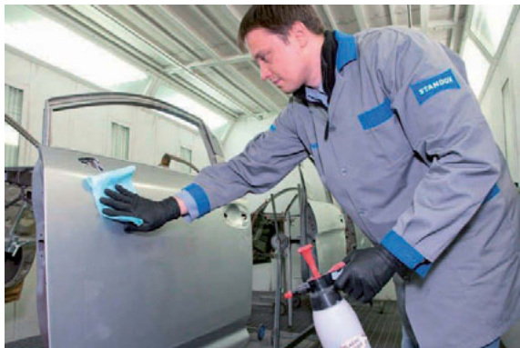
Foto 9 – Pind puhastatakse ühe puhastuslapiga...
