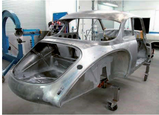
Foto 40– Soodaprittsiga puhastatud, haljas teraskere
