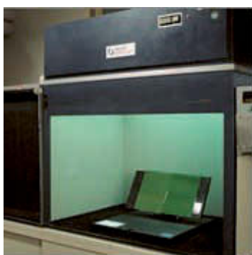
Fotod 11 ja 12 – Metameeria riski vältimiseks kasutatakse värvivaatluskappe
