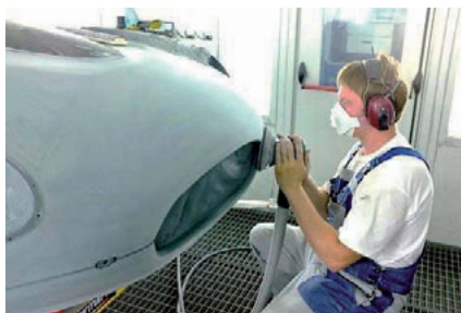
Fotod 2,3,4 – P2 klassi väljahingamisklapiga respiraator. Teisel pildil respiraatori korrektne ja kolmandal vale kasutamine
