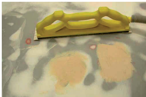
Fotod 73, 74 - Pahtli lihvimiseks sobivad erineva kuju ja suurusega lihvklotid ning -höövlid
