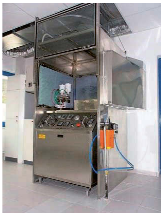
Foto 18, 19- Laboris tehakse värvidest proovipartiid ja värvitakse neist näidised
