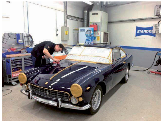
Foto 66 – Värvipinna peenlihvimine 3M™ Trizact P6000 kettaga
