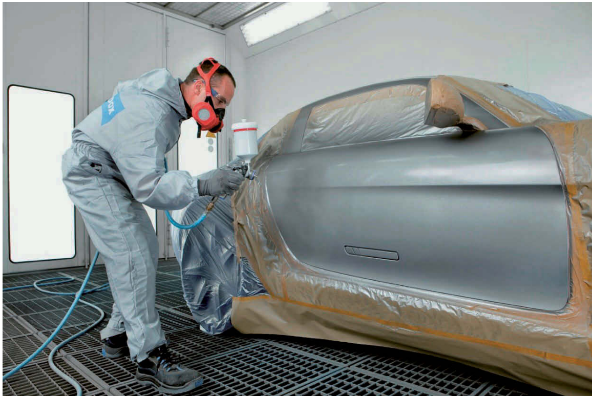
Foto 96 -Korrektne isikukaitsevahendite kasutamine värvimiskambris töötamisel
