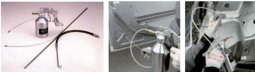
Fotod 45, 46, 47 – Professionaalseks kasutamiseks mõeldud korrosioonikaitse materjalide püstol (SATA)
