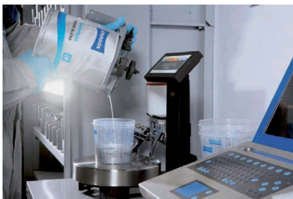
Foto 37 – 4. Värv valmissegamine elektronkaalu abil
