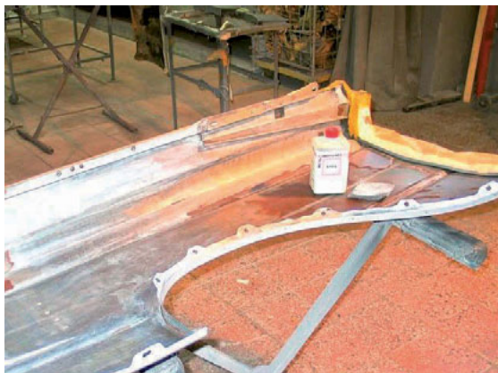
Fotod 41 ja 42 – DuPont Metal Conditioner on fosforhappel põhinev spetsiaalne metallpindade puhasti ja passiveerija
