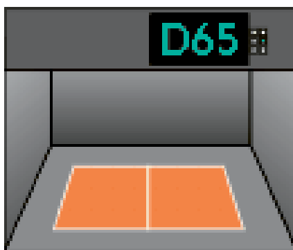
Fotod 11 ja 12 – Metameeria riski vältimiseks kasutatakse värvivaatluskappe
