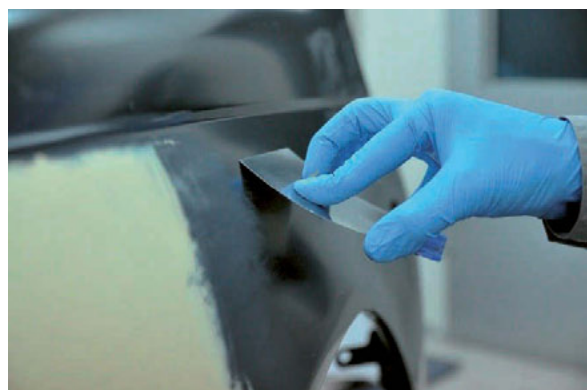
Foto 31 – pahtlilabida kasutamine siledal pinnal
