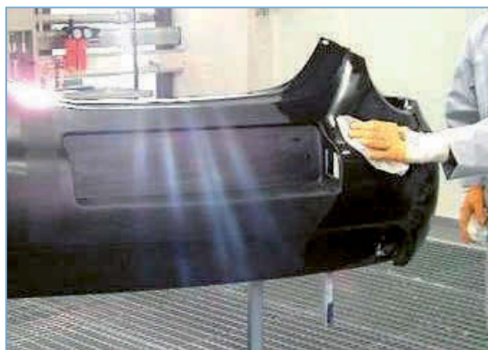
Foto 33 – Eemaldage vahajäägid ja mustus puhta lapiga
