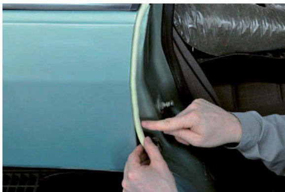
Fotod 25 ja 26 – Vahtteibi kasutamine uksevahede kaitseks auto külje värvimisel
