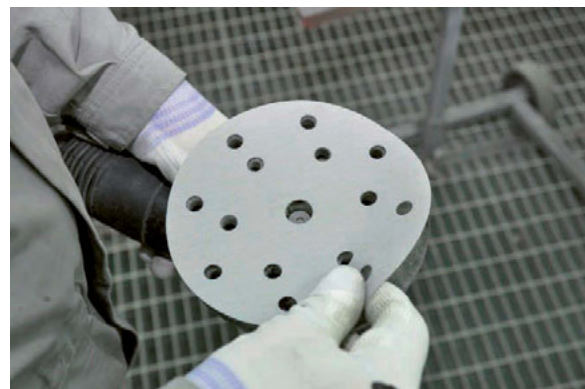
Foto 119 – Vahetald kinnitub alusele ja paber tallale krõpsuga
