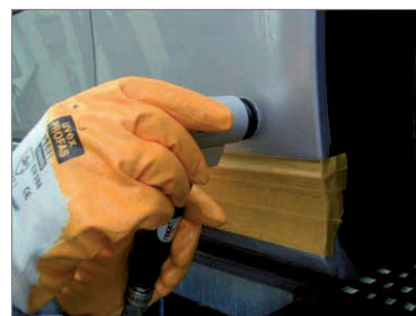
Foto 76 – Micro-orbitaalihvija töös
