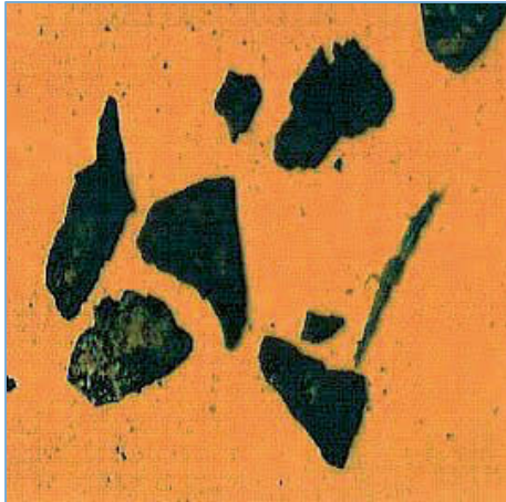
Joonis 6 – FEPA standardile mittevastava ja vastava abrasiivi osakesed
