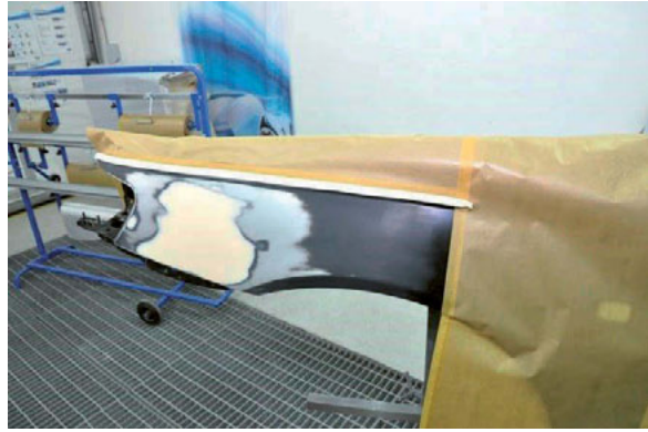
Foto 102 – Detail on valmis osaliseks kruntimiseks!
