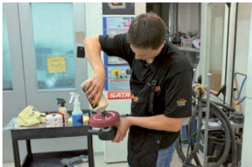
Fotod 117 ja 118 – Defektide eemaldamine SMAT-tehnoloogial lihvimispastaga (M101 + punane poleerimis padi)
