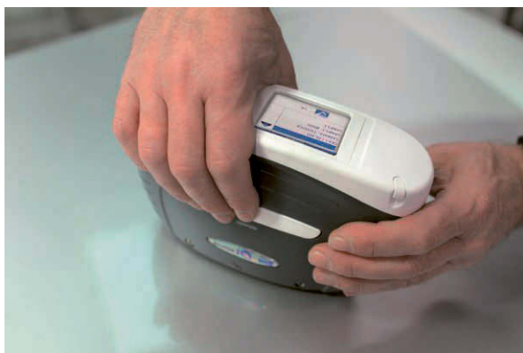
Foto 34 – 1. Auto värvuse mõõtmine fotospektromeetriga
