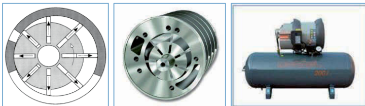
Joonis 19 – Lamellkompressori tööpõhimõte
