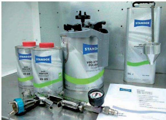
Foto 105, 106, 107 – Sobivad vahendid täitevkrundi töösegu tegemiseks. Krundi segamine mõõduanas, viskoossuse mõõtmine
