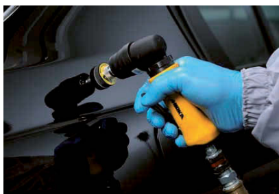
Foto 75 – MIRKA 32mm orbitaalihvija töös
