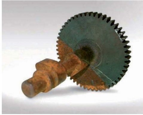
Foto 51 – Evapo-Rust'iga puhastatud terasdetail
