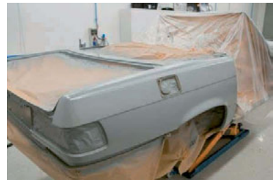
Foto 89 – Lihvitav 2K täitevkrunt pinnal
