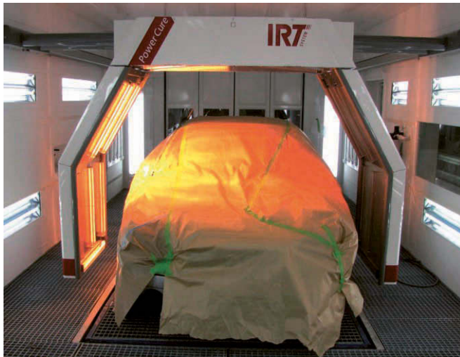
Foto 106 – Värvikambrisse paigaldatud programmeeritav IR-kuivatuskaar (IRT)
