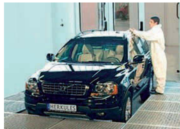
Fotod 179, 180, 181 – Erinevad autot ratastest tõstvad maalritõstukid. Ratastest tõstmisel on karbid vabad värvimiseks
