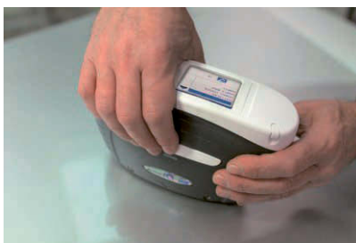
Fotod 147, 148 – Värvuse mõõtmine eelpooltoodud spektromeetritega
