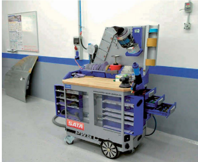
Foto 166, 167 – Spetsiaalne maalri tööjaam koos integreeritud tolmuimemissüsteemiga (PWS, München)
