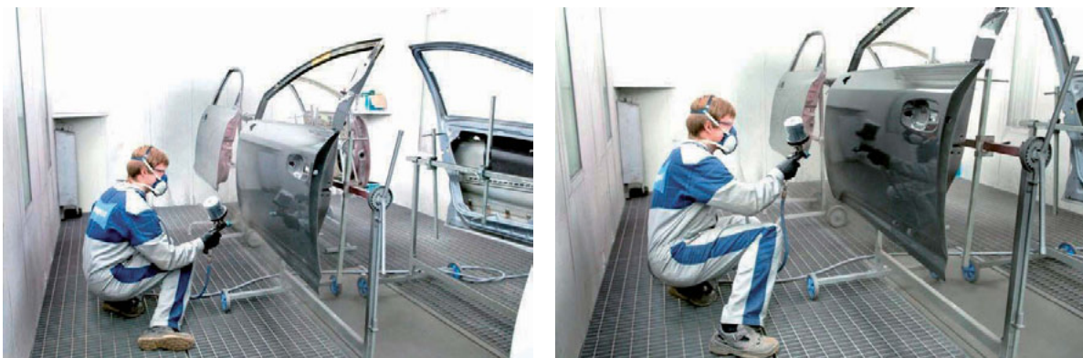
Fotod 84, 85 – Alustage värvimist detaili alaosast, nii väldite kuiva pihustustolmu sattumist veel värvimata pinnale
