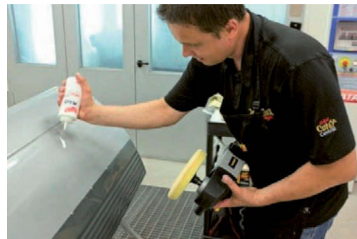
Foto 120 – Poleerpasta levitamine pinnale
