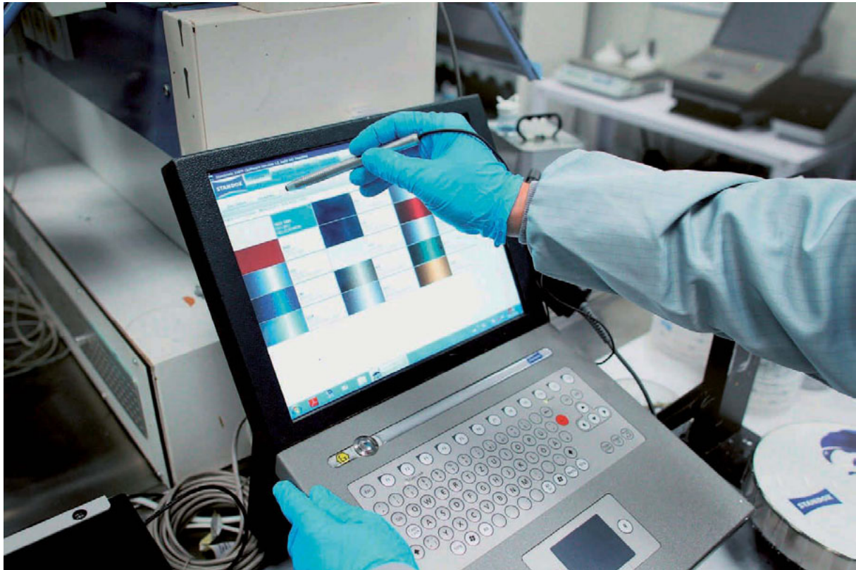
Foto 130 – Soovitud värvuse otsimine EX-klassi värvisegamisarvuti digitaalsest värvuskataloogist (Standex)
