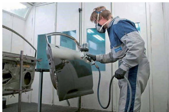
Foto 108, 109 – Eraldi detailide üleni kruntimisel alustage täitevkrundi pihustamist detaili alaosast ja liikuge järk-järgult ülespoole
