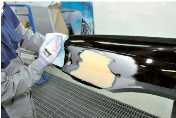
Fotod 84, 85 – Enne teistkordset pahteldamist puhastage pind silikoonieemaldiga ja seejärel kuivatage korralikult suruõhuga
