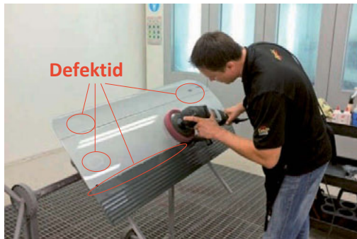
Fotod 117 ja 118 – Defektide eemaldamine SMAT-tehnoloogial lihvimispastaga (M101 + punane poleerimis padi)
