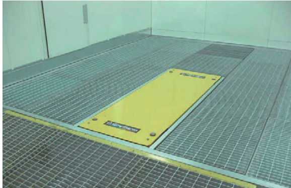
Foto 177 – Karpidest tõstev tõstuk suletud asendis kambris
