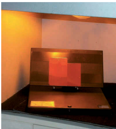
Fotod 20,21,22 - Värvinäidiseid võrreldakse erineva temperatuuriga valguse käes, ja lõpliku otsuse teeb kolorist
