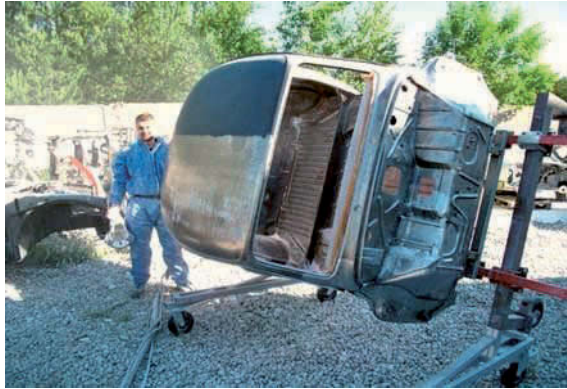
Foto 39 – Auto kere puhastamine soodapritsimise abil
