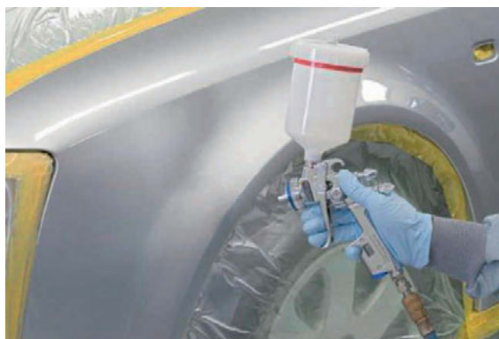
Foto 57 – Alusvärviga kaetud pinna lakkimine
