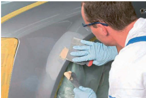
Foto 50 – Pahtli kasutamine ebatasasuste täitmiseks
