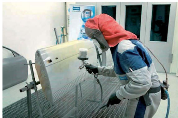
Foto 104 – Aluskrunditud pinna katmine täitevkrundiga
