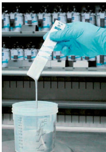
Fotod 46 ja 47 – Segage värvikomponendid hästi läbi ja värv on pihustamiseks valmis.
