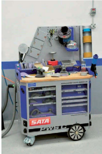
Foto 166, 167 – Spetsiaalne maalri tööjaam koos integreeritud tolmuimemissüsteemiga (PWS, München)
