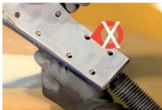
Foto 79 - Valesti klotstile paigaldatud lihvpaber
