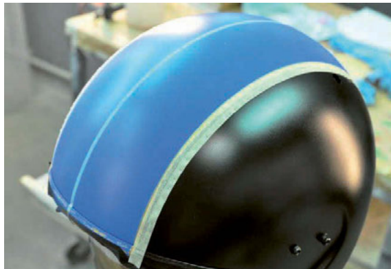
Foto 33 – Disainteip võimaldab katta keeruka kujuga objekte Foto 34 – Disainteibi kasutamisel jäävad värviservad täpsed
