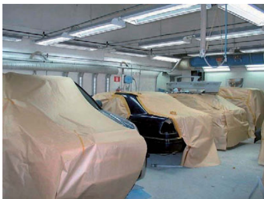
Fotod 19 ja 20 – Enne eeltöö alustamist kaetud autod, sama kattepaber puhastatakse ja kasutatakse ka värvimisel
