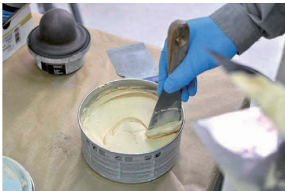
Foto 54 – Võtke kitsa labidaga purgist ühtlane kiht pahtlit
