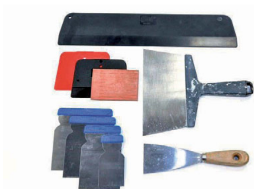
Foto 30 – Komplekt pahtlilabidad autode pahteldamiseks
