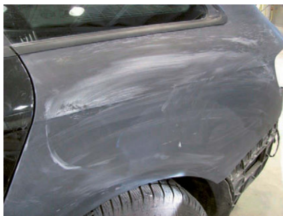
Foto 69 – Ebapiisavalt puhastatud aluspind, nähtav tolm
