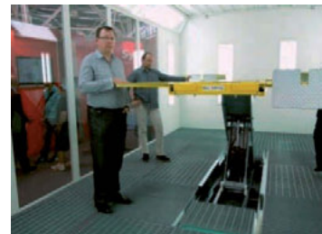
Fotod 179, 180, 181 – Erinevad autot ratastest tõstvad maalritõstukid. Ratastest tõstmisel on karbid vabad värvimiseks
