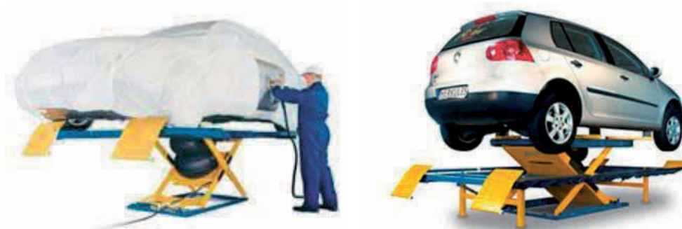
Fotod 175, 176 – Spetsiaalsed automaalri eeltööks sobivad tõstukid (Herkules)
