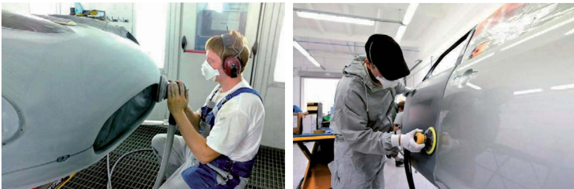
Fotod 112, 113 - Kuivanud täitevkrundi pinna lihvimine on vastutusrikas ülesanne ja nõuab sobivaid tööriistu ja oskusi
