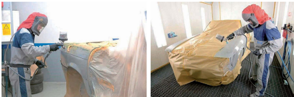
Fotod 110, 111 – Ka suuremate kruntmistööde korral, kui pinnad krunditakse üleni, on soovitatav liikuda alt üles
