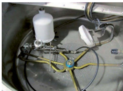
Fotod 61, 62 – Korrektelt töökorda seatud Drester 9000-TT püstolipesumasin
