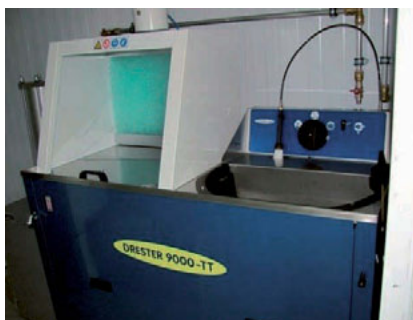
Fotod 61, 62 – Korrektelt töökorda seatud Drester 9000-TT püstolipesumasin
