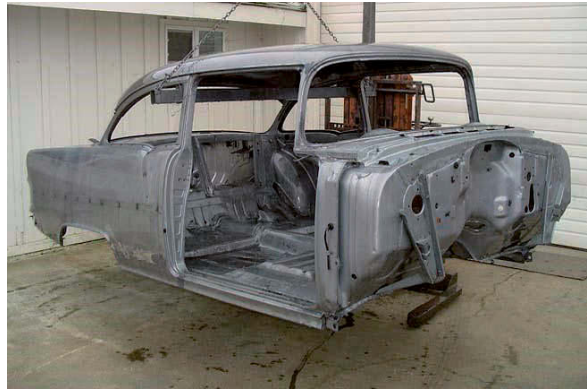
Foto 44 – Peale tötlust jääb alles vaid haljas metall
