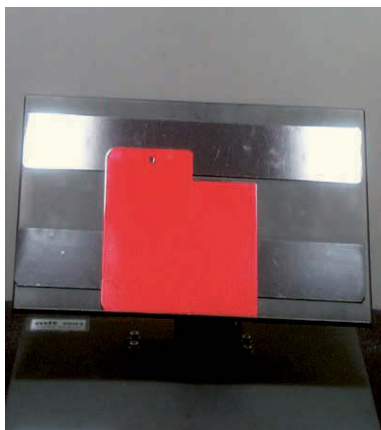
Fotod 20,21,22 - Värvinäidiseid võrreldakse erineva temperatuuriga valguse käes, ja lõpliku otsuse teeb kolorist
