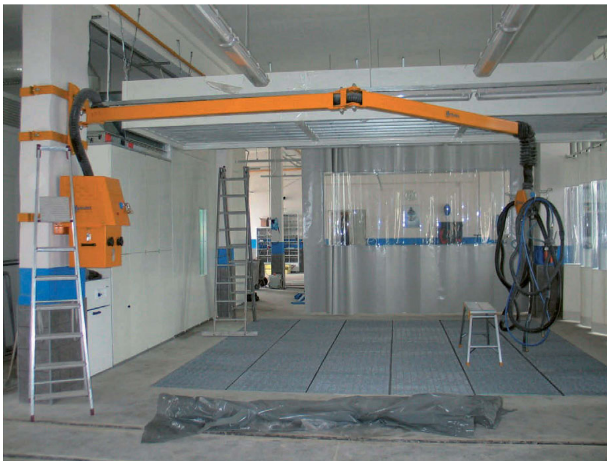
Foto 89 - Avatud seintega Blowtherm kruntimiskamber AK Autoteenindus OÜ, Rakveres
