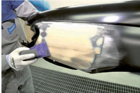
Foto 70 – Lihvige pahtlikiht sirgeks lihvklotsiga P80-P120
