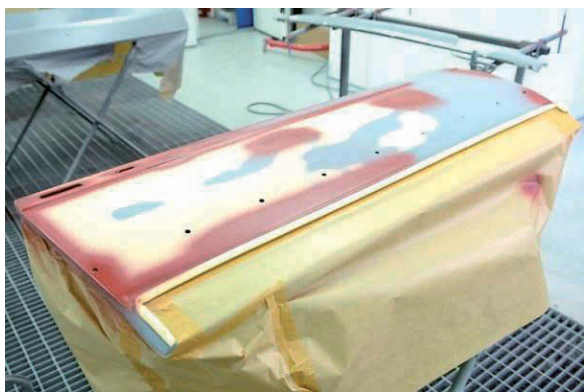
Fotod 88, 89 - Haljad metallipinnad on krunditud enne pritspahtli kandmist pinnale. Pane tähele vahteibiga kaetud servasid!
