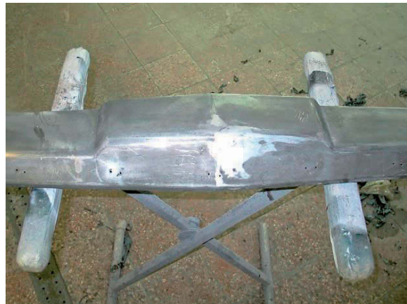
Foto 53 – Täielikult värvikihist puhastatud metallipind
