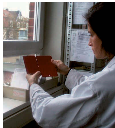
Fotod 20,21,22 - Värvinäidiseid võrreldakse erineva temperatuuriga valguse käes, ja lõpliku otsuse teeb kolorist
