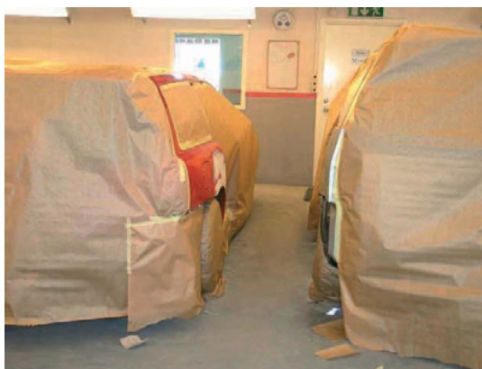
Fotod 19 ja 20 – Enne eeltöö alustamist kaetud autod, sama kattepaber puhastatakse ja kasutatakse ka värvimisel
