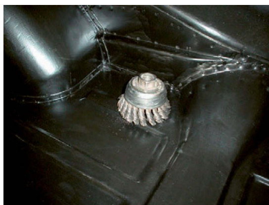
Foto 46 – Eelnevalt puhastatud ja POR 15® kaetud pind
