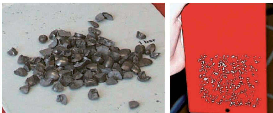
Foto 154 – Testimisel kasutatavad teravad haavlid 4-5 mm ja testpaneel peale testimist
