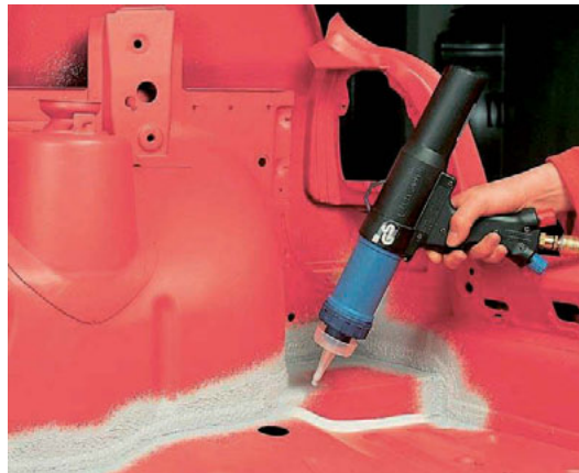
Foto 100 – Pihustatava mastiksi kasutamine
