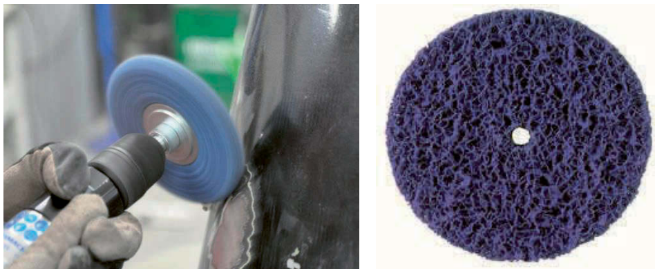
Fotod 61,62 – Kärgkettad on sobivad vana värvi ja rooste eemaldamiseks ilma metalli õhemaks lihvimata
