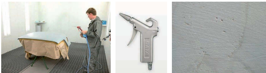
Fotod 11,12,13 - Suruõhuga puhastades õnnestub tolm ka sügavatest pooridest hõlpsasti eemaldada
