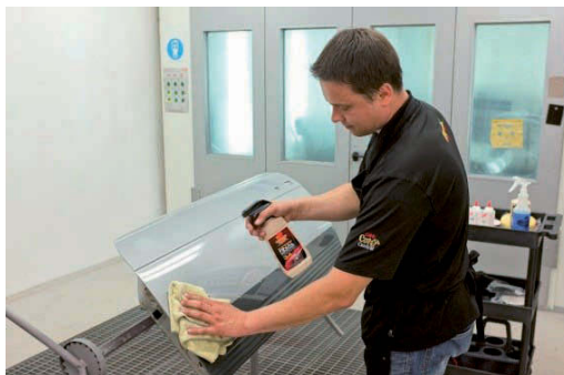
Foto 119 – Pinna puhastamine ja kontroll (M34)
