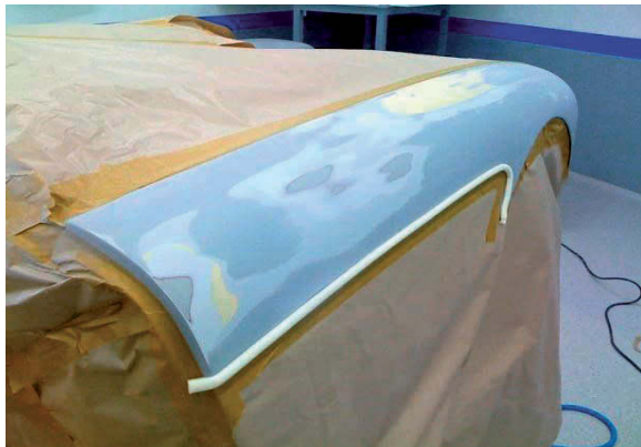
Fotod 23 ja 24 – Vahtteipi saab edukalt kasutada kruntimisel sujuvate üleminekute tegemiseks
