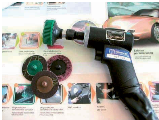
Foto 35 – Roloc-lihvija on tõhus rooste eemaldaja
