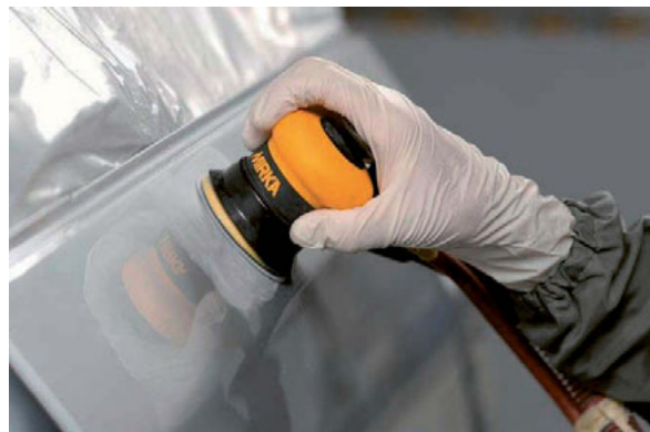
Foto 54 – 75 mm lihvketta kasutamine peenlihvimisel masinaga
