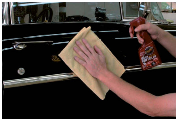
Foto 126 – Värvipinna puhastamine Pinnahooldusvahendiga
