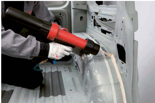
Foto 99 – Spetsiaalse otsikuga liitekohtadesse paigaldatav mastiks
