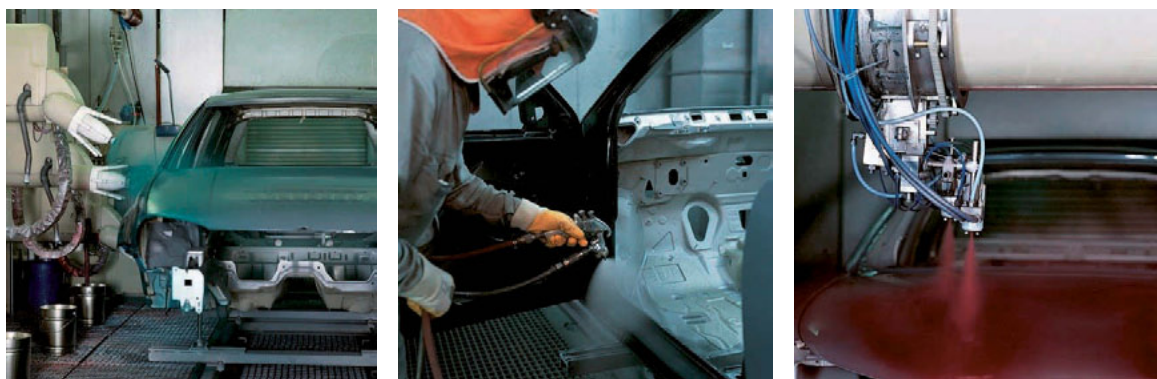
Fotod 42, 43 ja 44 – Autode värvimise erinevad etapid ja menetlused autovalmistaja värvimisprotsessis.
