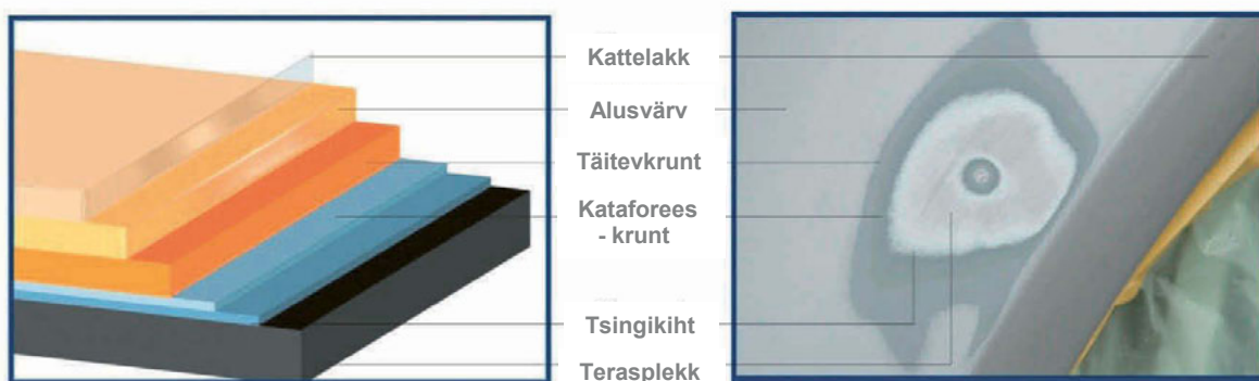
Joonis 5 – Metallini läbilihvitud, originaalvärvkattega auto detaili pinnal paljanduvad erinevad värvkatte kihid
