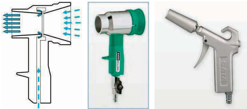
Foto 97 – Suruõhu puhuri tööpõhimõte. Fotod 98, 99 – erinevad suruõhu puhurid
