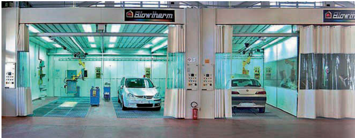
Foto 86 - Mitmekohaline kruntimiskamber koos töökohtade vahel asuvate kardinatega (Blowtherm S.p.a.)
