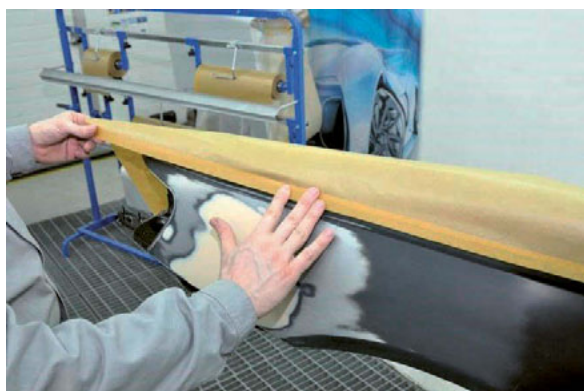
Foto 99 – Kasutage osalisel kruntimisel katmist mööda kante
