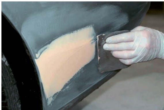
Foto 66 - Korrektselt pahteldatud pind
