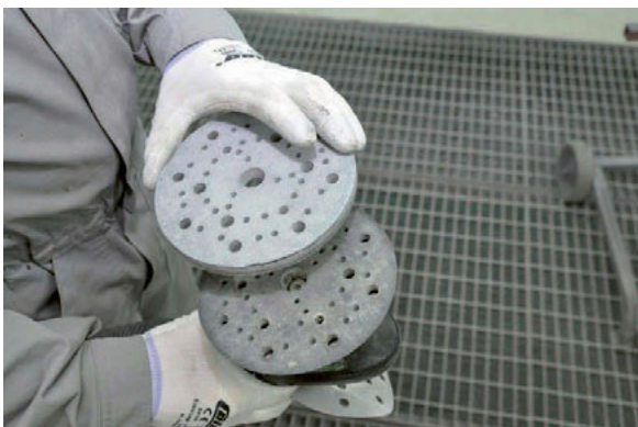
Foto 118 – Kasutage viimistluslihvimisel pehmet vahetalda
