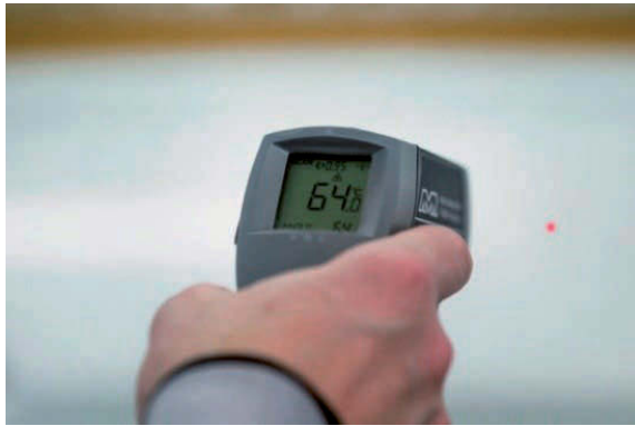
Foto 152 - Pinna temperatuuri mõõtmine Infrapuna-termomeetriga (näit. 64 °C)
