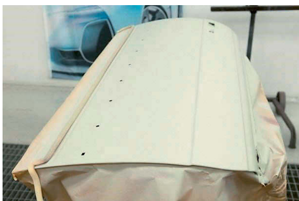
Foto 90 -Kuivanud pritspahtel – kihi paksus 200-400 µm
