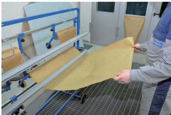
Foto 26 – Kattepaber tõmmatakse vajalikus pikkuses välja...
