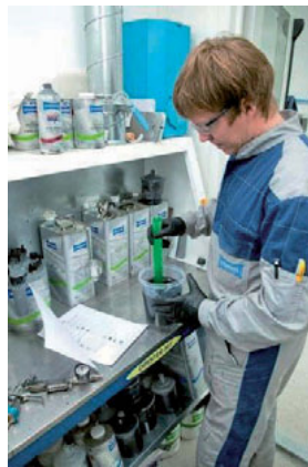
Foto 105, 106, 107 – Sobivad vahendid täitevkrundi töösegu tegemiseks. Krundi segamine mõõduanas, viskoossuse mõõtmine
