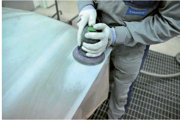
Foto 117 – Alles peale seda lihvitakse masinaga pind ühtlaseks
