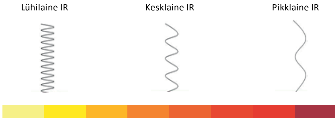
Joonis 31 – Infrapunakiirguri lainepikkused ja liigitus lainepikkuste järgi
