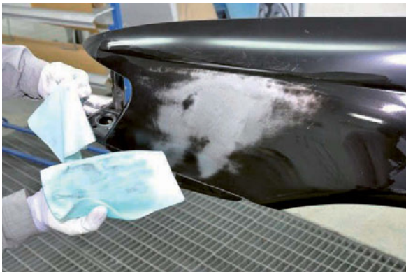
Foto 93 – Lihvige vigastatud ala puhtaks lihvmasinaga P180
