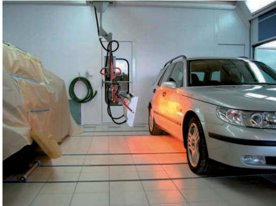
Fotod 104,105 – Relsisüsteemile paigaldatud IR-kuivati (IRT)
