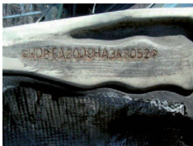
Foto 32 – keredetailile pressitud VIN-kood
