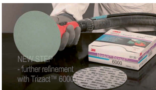
Foto 104 – Viimistluslihvimine 150 mm Trizact kettaga märjalt
