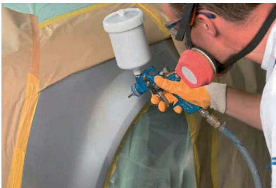
Foto 54 – Pinna katmine täitevkrundiga
