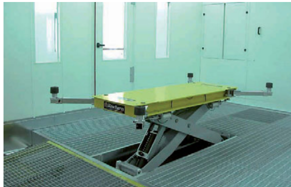
Foto 178 – Sama tõstuk avatud asendis (Blowtherm)
