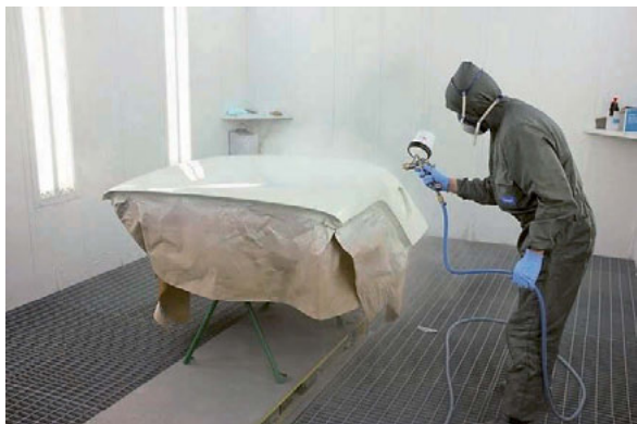
Fotod 93, 94 – Värvikambri hankimisel peaks kindlasti eelistama täisrest-põrandaga värvikambreid
