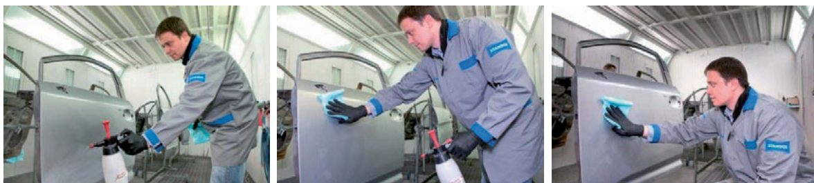
Fotod 65,66,67 – Korrektne pinna ettevalmistamine värvimiseks, kasutades puhastamist kahe puhastuslapiga
