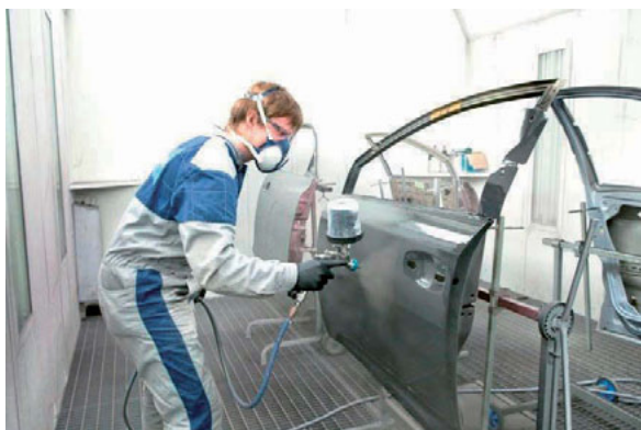
Fotod 86, 87 – Jätkake, liikudes üles ja pöörake erilist tähelepanu pealmiste pindade viimistlemisele
