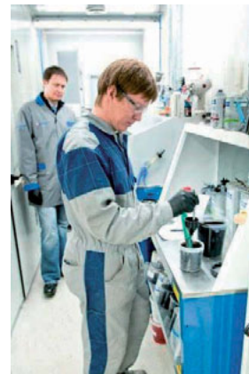
Foto 105, 106, 107 – Sobivad vahendid täitevkrundi töösegu tegemiseks. Krundi segamine mõõduanas, viskoossuse mõõtmine
