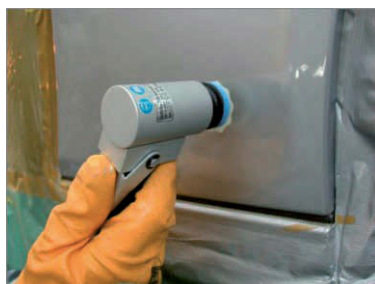
Foto 74 – 32 mm orbitaalihvija töös
