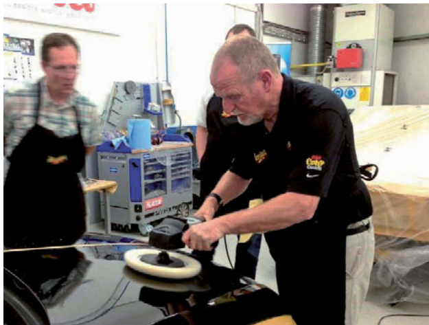
Foto 128 – Pöörleva tallaga poleerimismasina kasutamine
