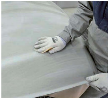
Foto 57– Lihvimine pehmel alusel käsilihvpaperiga ja käsilihvpaperi pakend
