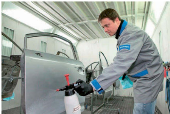
Fotod 7 ja 8 – Pesuaine pihustatakse pinnale ühtlase kihina, kasutades selleks mõeldud survepudelit
