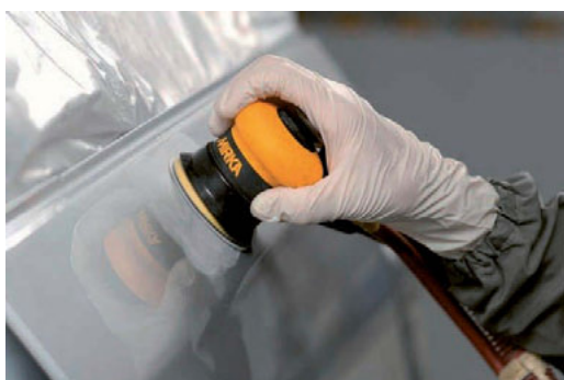
Foto 103 – Viimistluslihvimine kuvalt 77 mm kettaga
