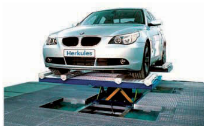
Fotod 179, 180, 181 – Erinevad autot ratastest tõstvad maalritõstukid. Ratastest tõstmisel on karbid vabad värvimiseks
