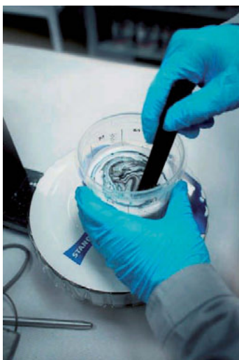
Fotod 46 ja 47 – Segage värvikomponendid hästi läbi ja värv on pihustamiseks valmis.
