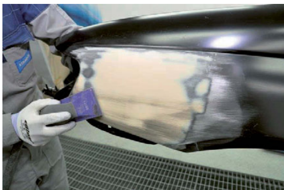
Foto 55 – Pahtli lihvimiseks kasutatakse pinnatud abrasiivi
