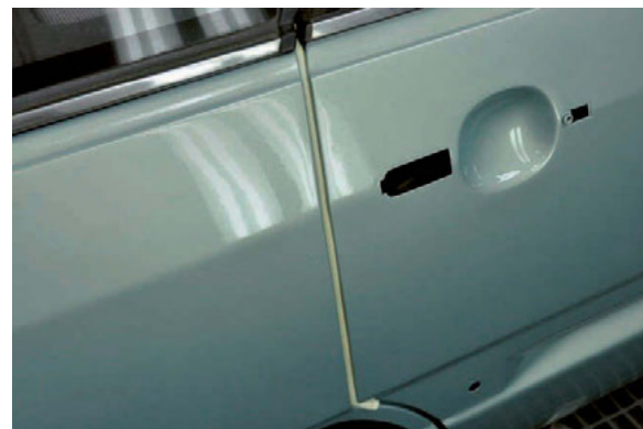
Fotod 23 ja 24 – Vahtteipi saab edukalt kasutada kruntimisel sujuvate üleminekute tegemiseks
