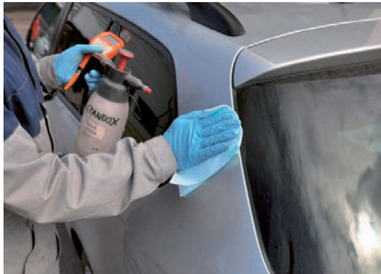
Foto 140 – Pind tuleb enne mõõtmist puhastada
