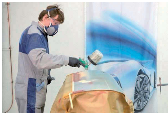
Fotod 88, 89 - Haljad metallipinnad on krunditud enne pritspahtli kandmist pinnale. Pane tähele vahteibiga kaetud servasid!
