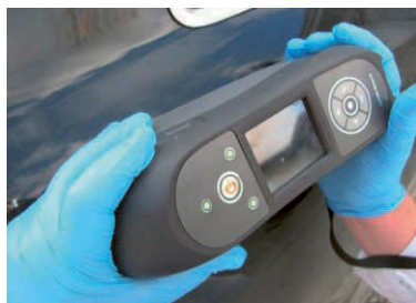
Fotod 147, 148 – Värvuse mõõtmine eelpooltoodud spektromeetritega
