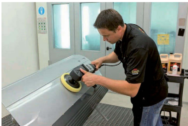
Foto 91 - Poleerimine defektide eemalduseks peale värvimist
