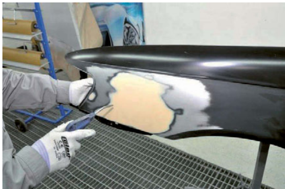
Fotod 84, 85 – Enne teistkordset pahteldamist puhastage pind silikoonieemaldiga ja seejärel kuivatage korralikult suruõhuga
