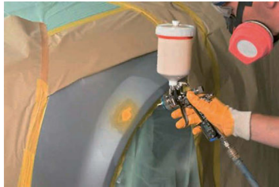
Foto 53 – Halja metalli katmine korrosioonikaitse krundiga
