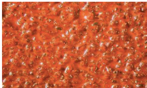
Foto 50 – Tiheda (suletud) kattega abrasiiv
