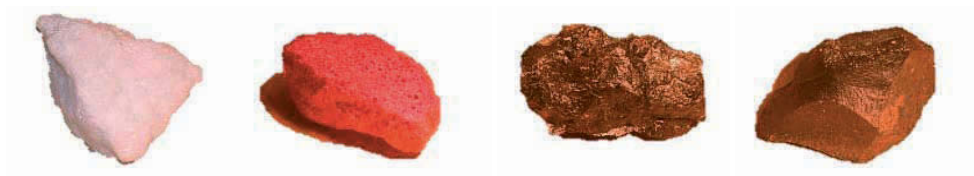
Foto 41 – Erinevad alumiiniumoksiidi vormid (KWH MIRKA)
