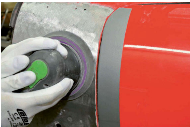
Foto 35 – Kaitseteip säästab töödeldava detaili kõrval asuvat detaili vigastustest
