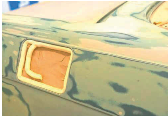
Fotod 23 ja 24 – Vahtteipi saab edukalt kasutada kruntimisel sujuvate üleminekute tegemiseks
