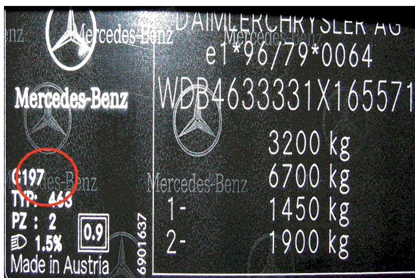
Foto 29 – MERCEDES-BENZ värvikoodi asukoht identifitseerimisplaadil
