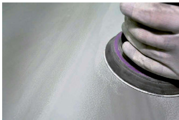
Foto 121 – Tänu kontrolltahmale on krundi pind hästi jälgitav
