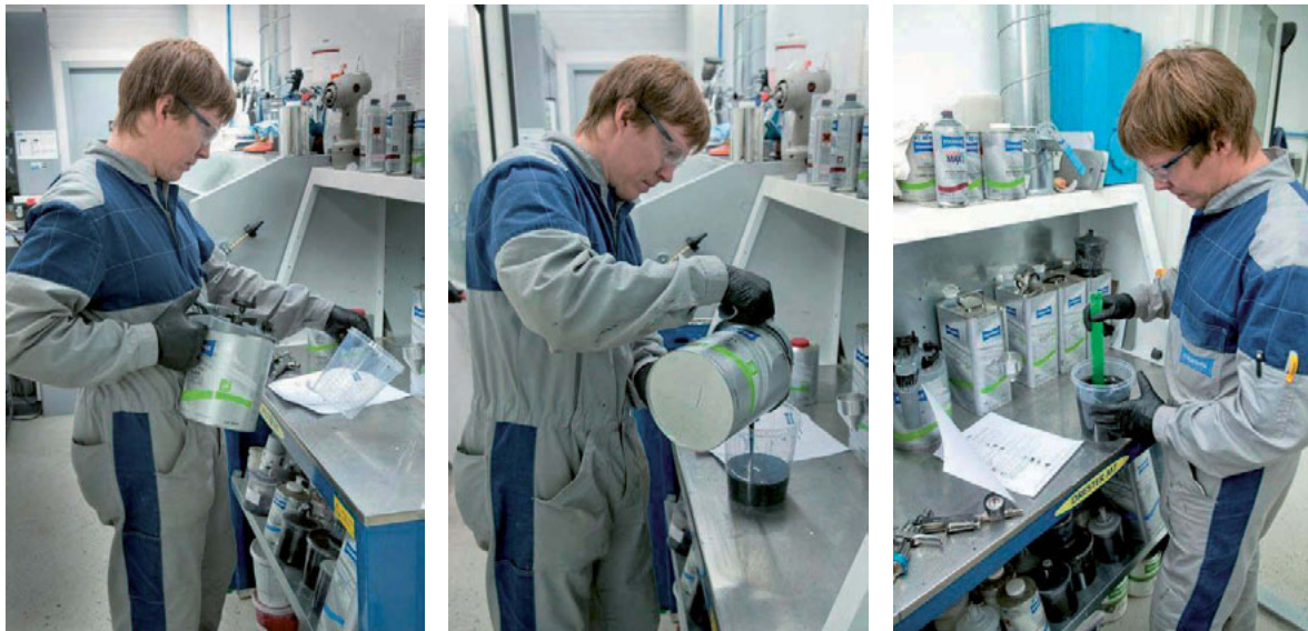
Fotod 94, 95, 96 - Täitevkrundi segamine, kasutades spetsiaalset segamissuhetega mõõduanumat
