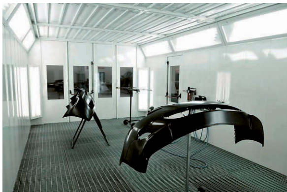
Fotod 93, 94 – Värvikambri hankimisel peaks kindlasti eelistama täisrest-põrandaga värvikambreid
